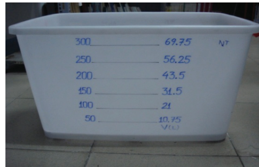
Hình 1 Mô hình thí nghiệm nuôi tảo Spirulina bằng nước thải tinh bột mì khi xáo trộn thủ công.
