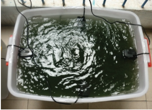
Hình 2: Mô hình thí nghiệm nuôi tảo Spirulina bằng nước thải tinh bột mì khi xáo trộn khác nhau (4 máy bơm nước hồ cá)
