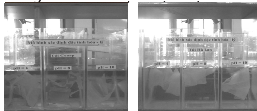
Hình 3 - Mô hình thí nghiệm đánh giá khả năng thủy phân của bao bì.
