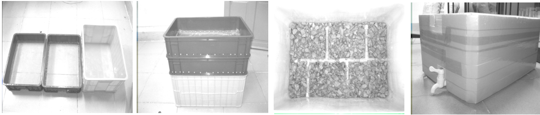
Hình 1 - Mô hình thí nghiệm đánh giá khả năng PSHH trong điều kiện ủ hiếu khí.
