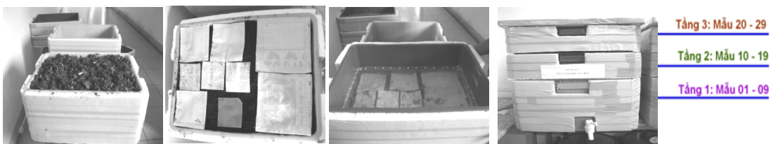
Hình 2 - Đặt mẫu túi nilon nghiên cứu vào mô hình ủ compost hiếu khí.
